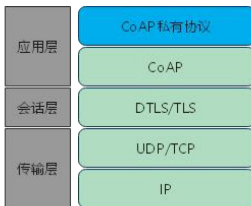
图7 NB-IoT 水表终端应用协议分层示意图
